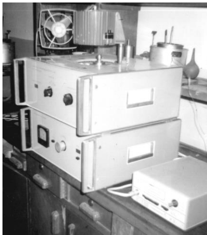
Рисунок 1 – Прибор ИТ-λ-400 для определения теплопроводности материалов
